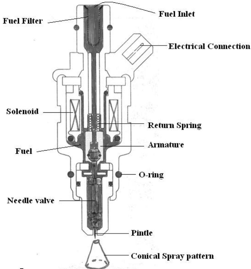
Fig. TOP FEED FUEL INJECTOR
